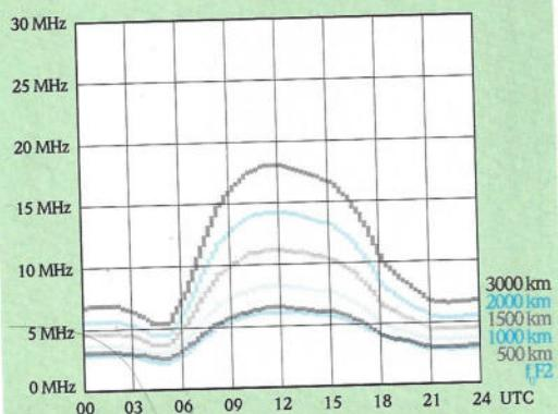
Die günstigste Frequenz für EU-QSOs ergibt sich, wenn man in dem Kasten links, auf der Kurve der gewünschten Entfernung [unterste Kurve 0 km (=  $f_{\text{F2}}$ ), oberste Kurve 3000 km], die Frequenz (links) für die gewünschte Uhrzeit (unten) abliest.
